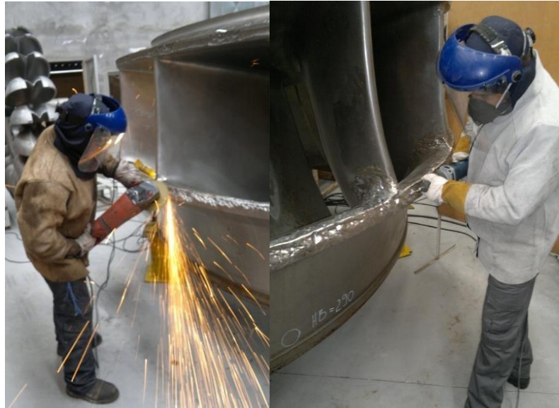
Figura 4.17 Uso de las amoladoras y rectificadoras
