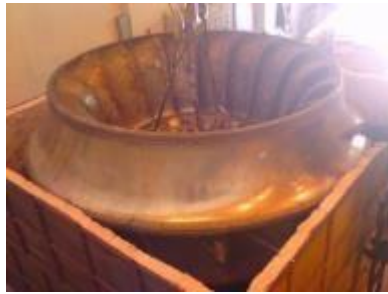
Figura 4.21 Rodete ingresando al horno de tratamiento térmico
