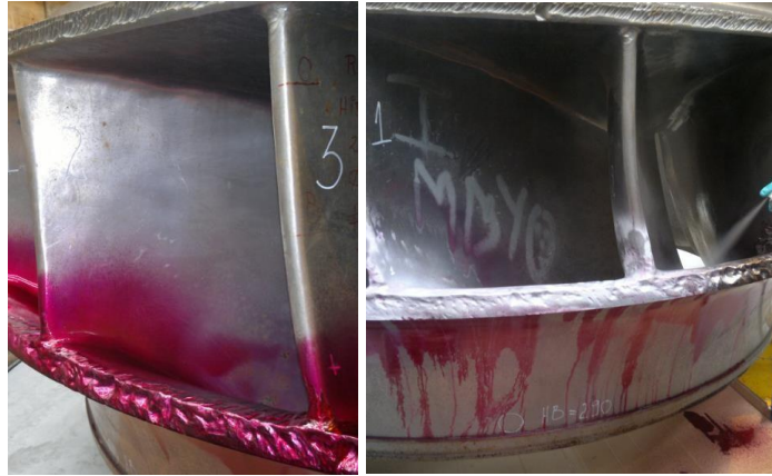
Figura 4.14 Aplicación de líquidos penetrantes
