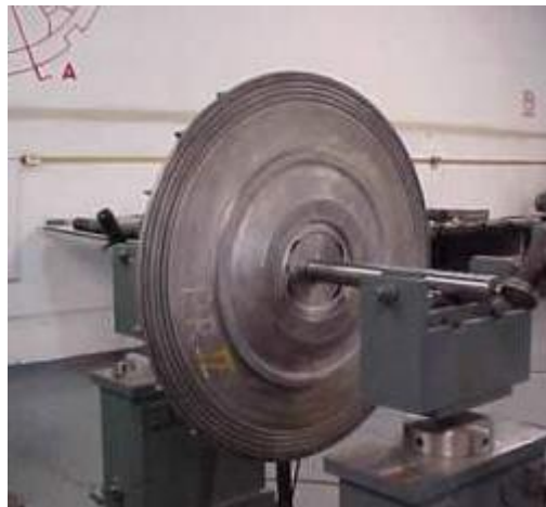
Figura 4.9 Modelo de Sistema de Balanceamiento estático
