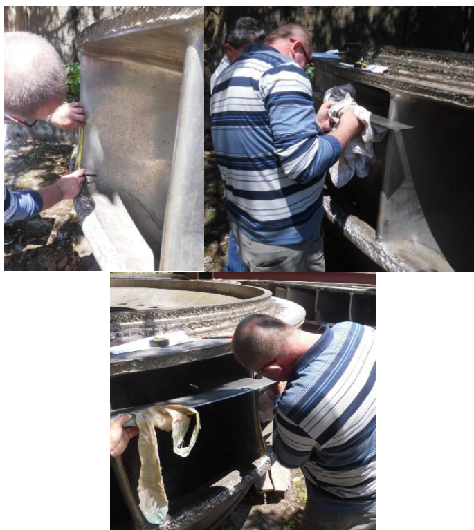
Figura 4.12 Desgastes admitidos en las partes del rodete
