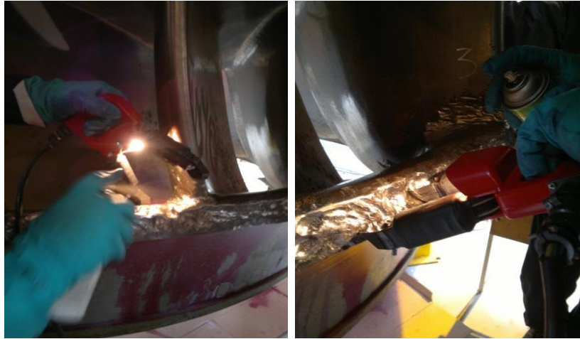
Figura 4.16 Inspección por partículas magnéticas
