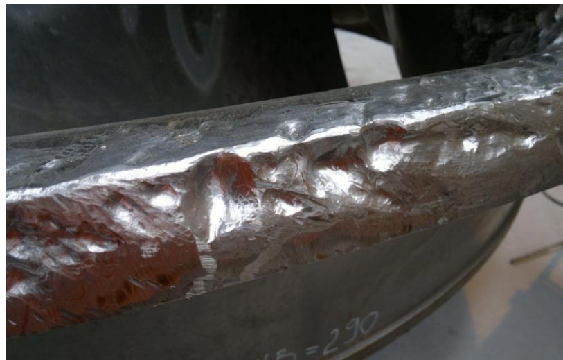
Figura 4.18 Pulido del laberinto de la corona
