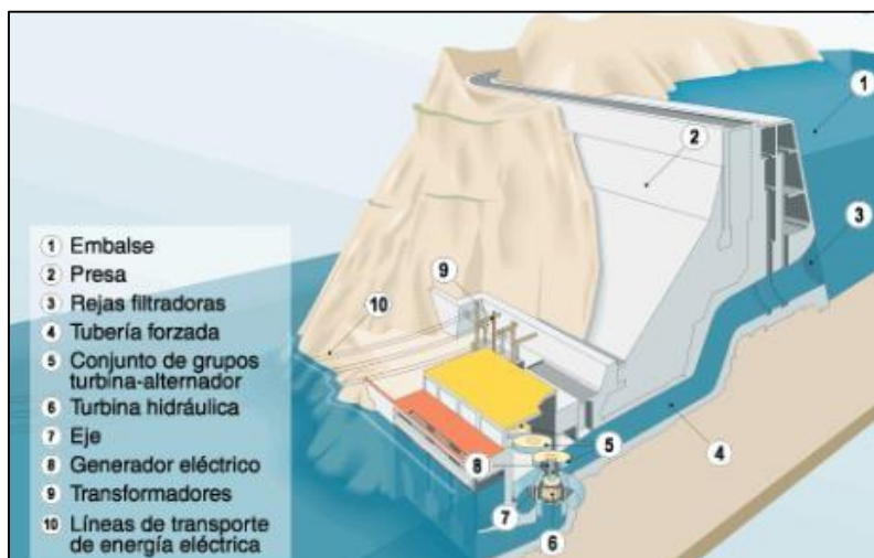
Figura 1.13 Esquema de una Central Hidroeléctrica [5]
