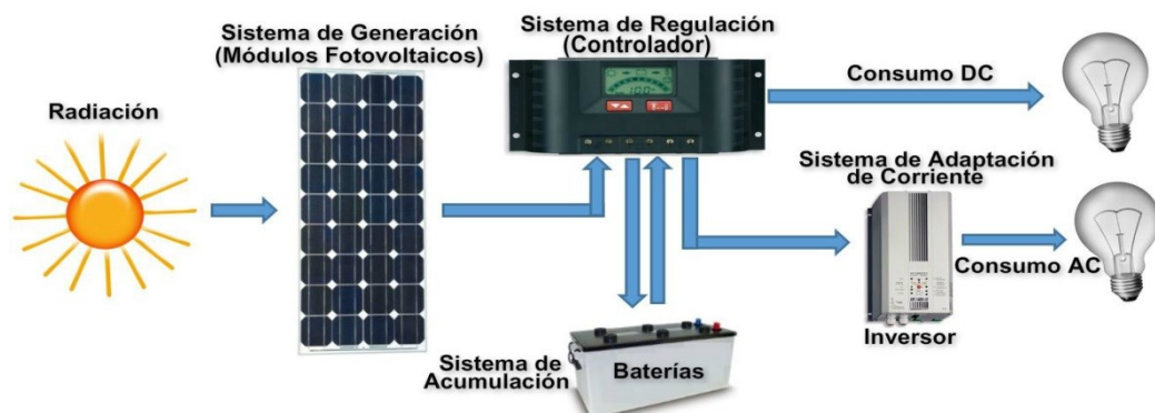
Figura 1.2 - Componentes de un sistema fotovoltaico aislado.
