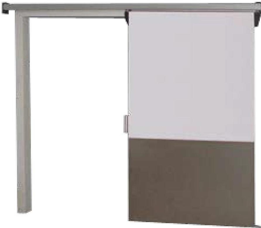
**Marco:** Perfil de aluminio extrusionado y posteriormente lacado en Blanco, con doble rotura de puente térmico. Este marco tiene la posibilidad de equiparse con resistencia para evitar la congelación del burlete en las cámaras de baja temperatura. Es adaptable a cualquier panel o a obra civil.
