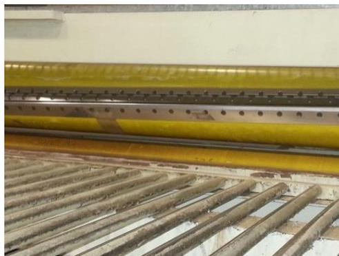
**FIGURA 2. 48 CORTADORA TRANSVERSAL**
