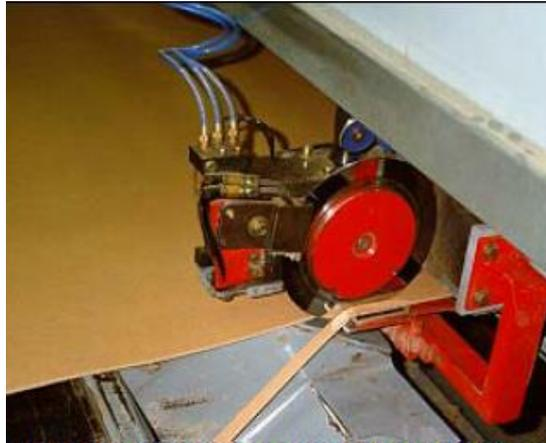
**FIGURA 2. 47 CORTADORA LONGITUDINAL**
