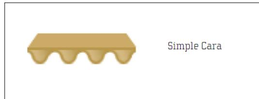
**FIGURA 2. 2 PARED SIMPLE O SINGLE FACE**
