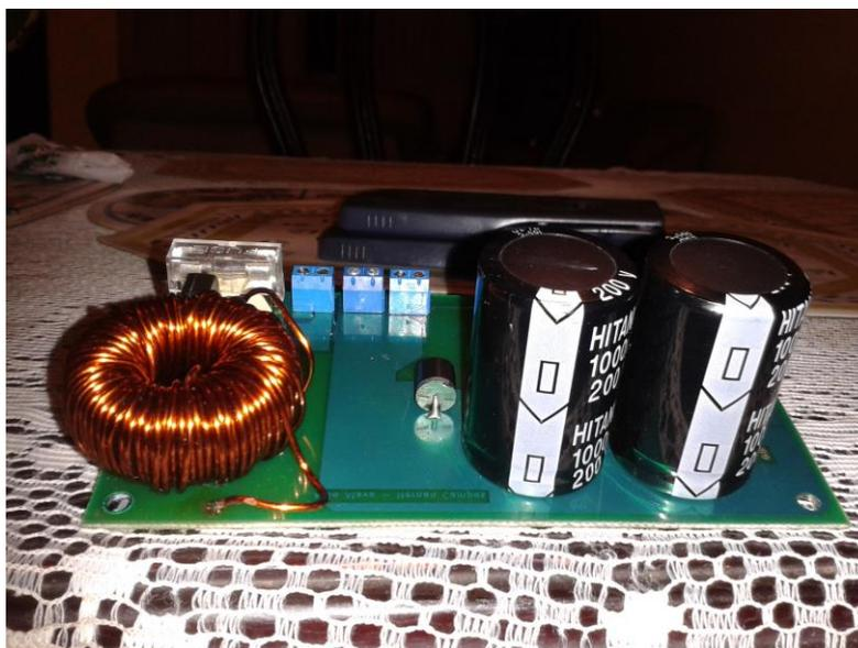
Figura 5.3. Parte superior de la placa electrónica del PFC.
