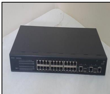
Figura 4.7 Switch con los puertos LAN utilizados
