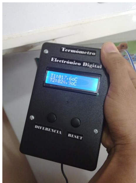
FIGURA 4.4 PRUEBA FÍSICA DE LA TOMA DE TEMPERATURA EN DOS GRADIENTES DISTINTOS.
