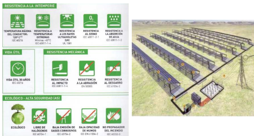
Figura 2. 16 Características del Cable y su colocación [17]
