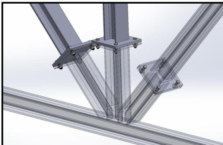
**FIGURA 2.28: UNIÓN CERCHA DE CUBIERTA [8].**
