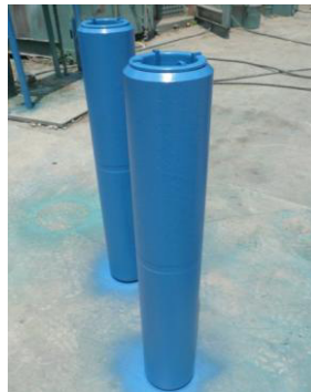
Fig 3.2 Bit Sub (Caja-Caja).
