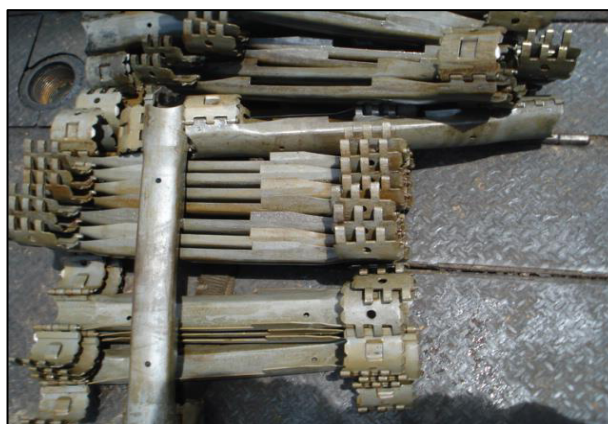
Figura 2.34: Protectores Cannon para asegurar el cable a la tubería.
