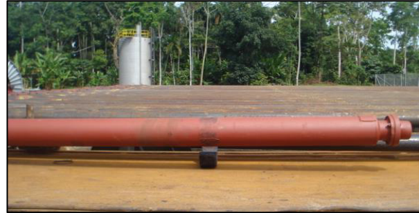
Figura 2.27: Motor de 225 HP
