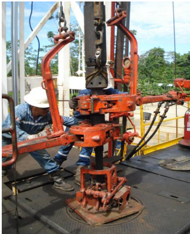
Figura 2.4: Llaves de Enrosque – Desenrosque.
