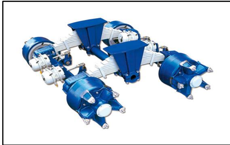
FIGURA 2.17: EJE DE RUEDA [6]
