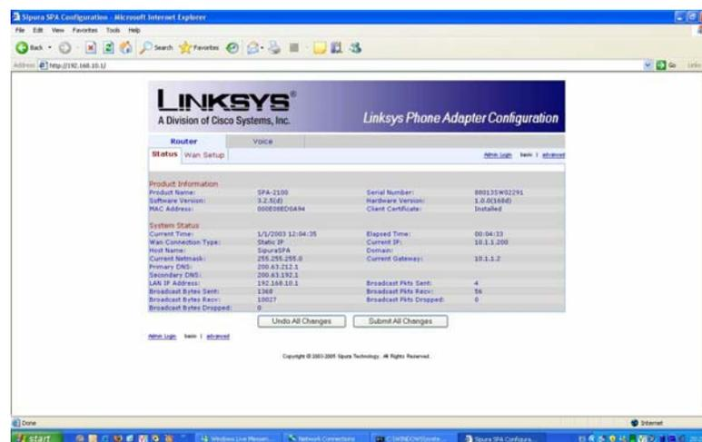
**Figura 3.8. Pantalla principal de configuración del ATA LINKSYS SIPURA**
