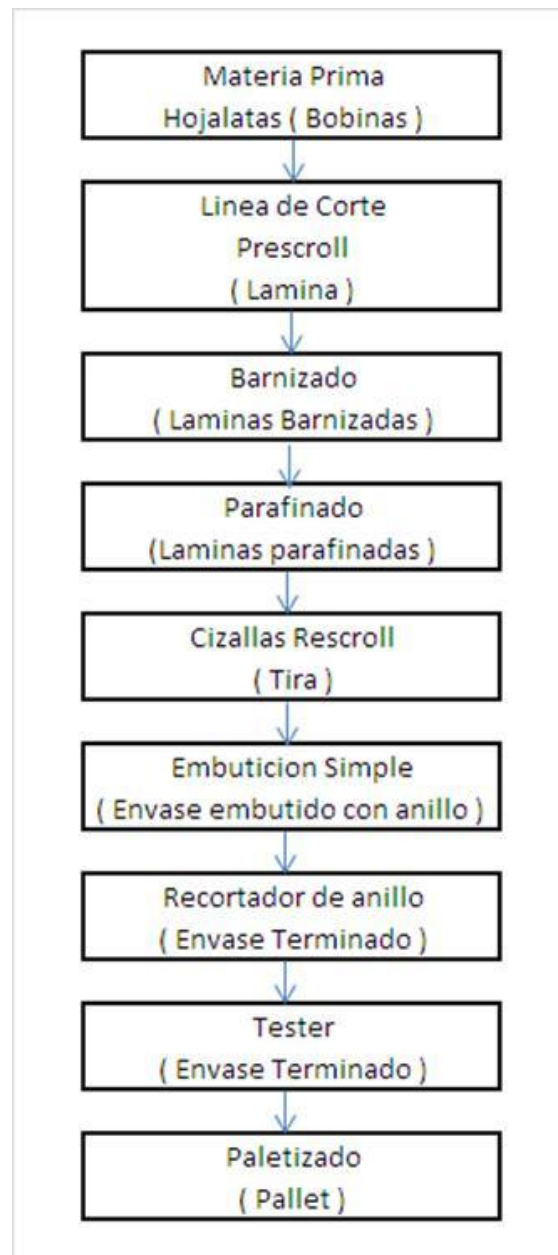
FIGURA 1.3 DIAGRAMA MORFOLÓGICO DEL PROCESO DE FABRICACIÓN DE ENVASES EMBUTIDOS
