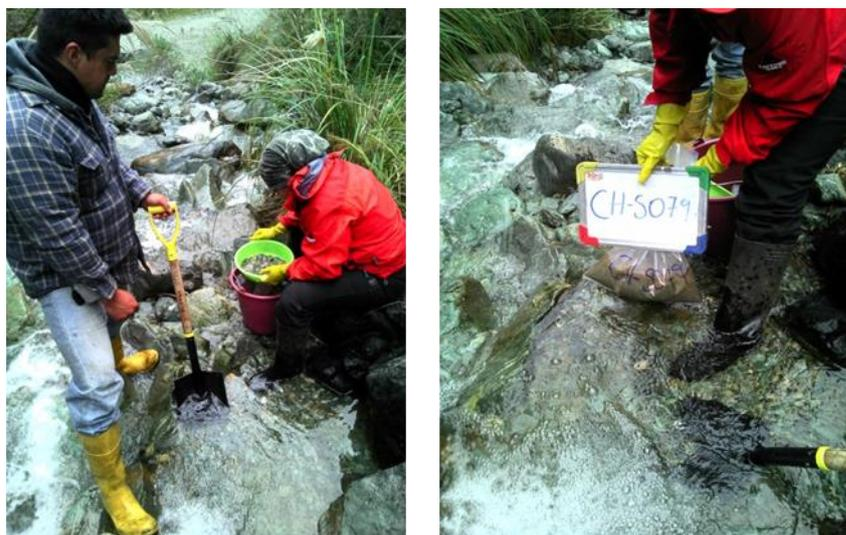
**Foto.- 17 Toma de muestras de sedimentos activos en el lecho del río en el margen central.**
