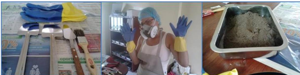
**Foto.- 18 Kit de implementos para la preparación y secado de las muestras**
