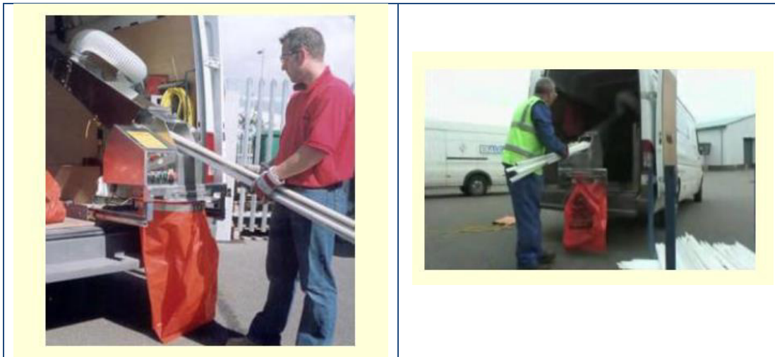
Gráfico 1. Máquina trituradora anexa a camión recolector en funcionamiento
