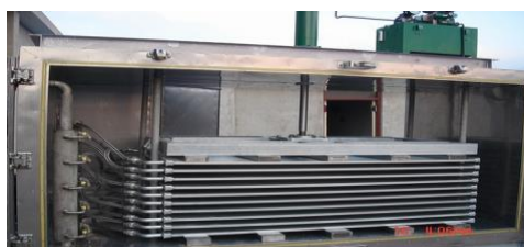
FIGURA 2.5 CONGELADOR DE PLACAS (Lista de productos Nantong Refriend Ice Systems Co. Ltd.)
