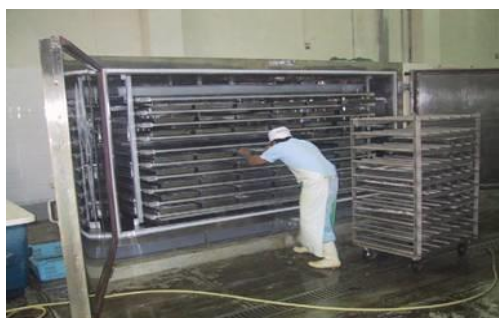
FIGURA 2.7 ESTIBADO DEL PRODUCTO EN EL CONGELADOR DE PLACAS (Pesca y Acuicultura.Seminario Virtual)
