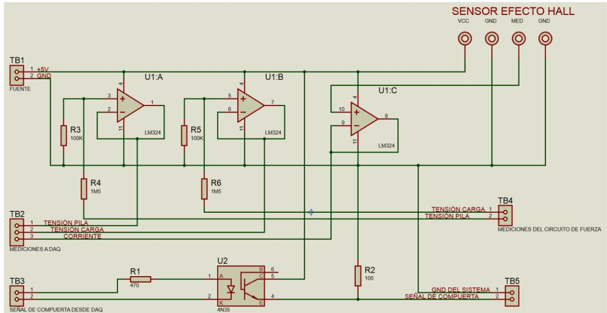
Figura 5.6 Circuito para medición y acondicionamiento de señales
