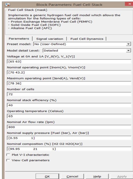
**Figura 3.4 Cuadro de Parámetros: Pila de combustible**
