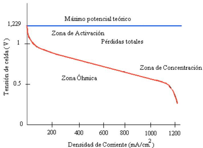
**Figura 2.2 Curva de Polarización de una PEM.[23]**
