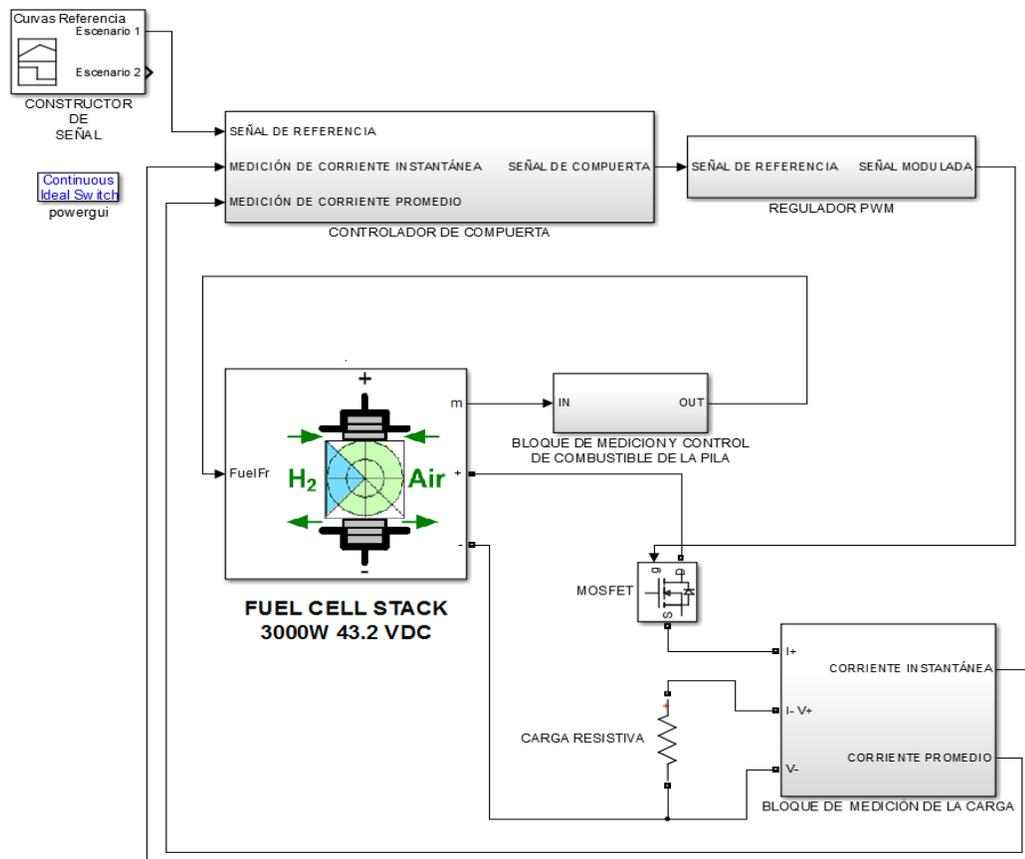
**Figura 4.1 Modelo del Emulador de Carga en Simulink**
