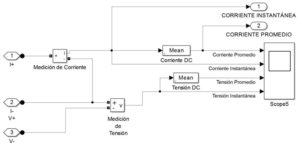
**Figura 4.18 Bloque de Medición de la Carga**
