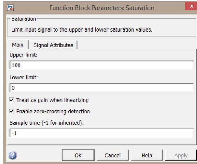
**Figura 4.16** Parámetros de bloque Saturation
