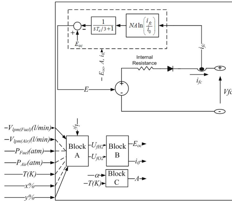
**Figura 3.3 Modelo matemático de la pila de combustible. [38]**
