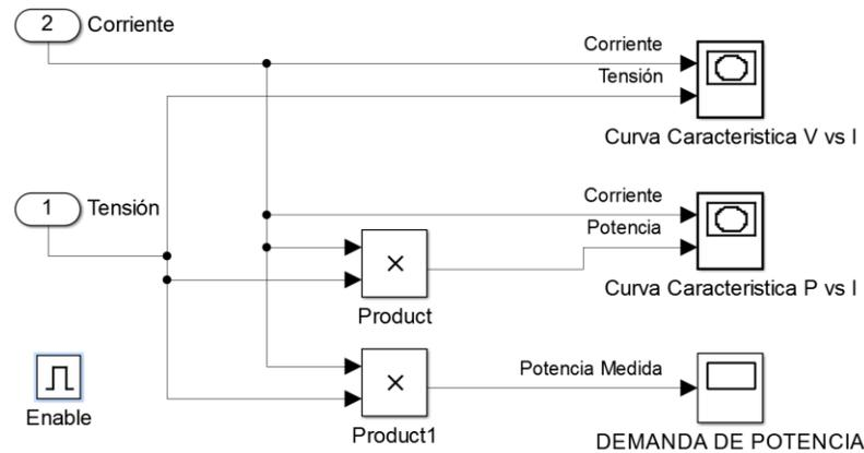
**Figura 4.5 Bloque de medición de Curvas Características**
