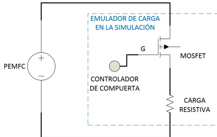
**Figura 3.2 Esquema eléctrico general de la simulación**
