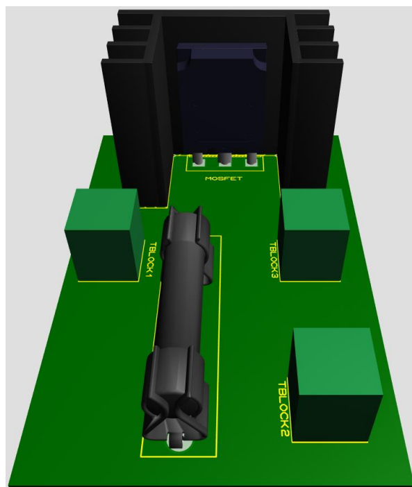
Figura 5.4 Vista 3D de la tarjeta de circuito de fuerza
