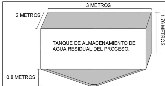
**FIGURA 3.10 GEOMETRÍA DE UN TANQUE DE ALMACENAMIENTO DE AGUA RESIDUAL DEL PROCESO.**
