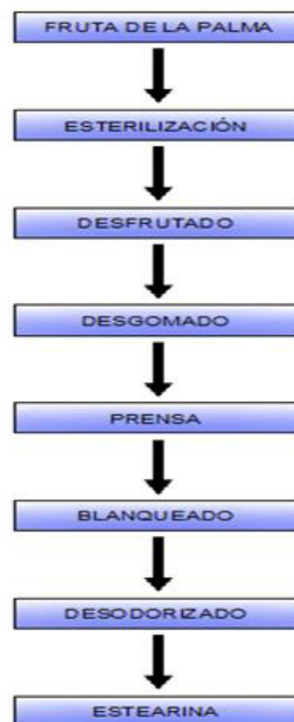
FIGURA 1.2 DIAGRAMA DE PROCESO PARA OBTENCIÓN DE ESTEARINA DE PALMA
