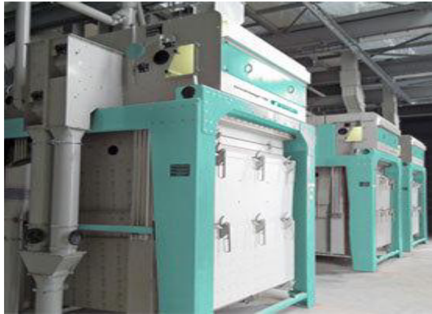
FIGURA 3.2 EQUIPO LIMPIADOR ASPIRADOR Y CLASIFICADOR DE GRANOS
