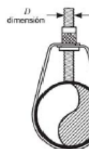
Pieza giratoria ajustable Argolla-varilla apretada a la tubería
