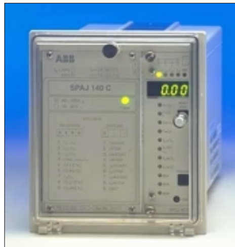
Figura N°1.3. Relé electrónico SPAJ 140C para la protección por sobrecorriente de la subestación Santa Rosa.
