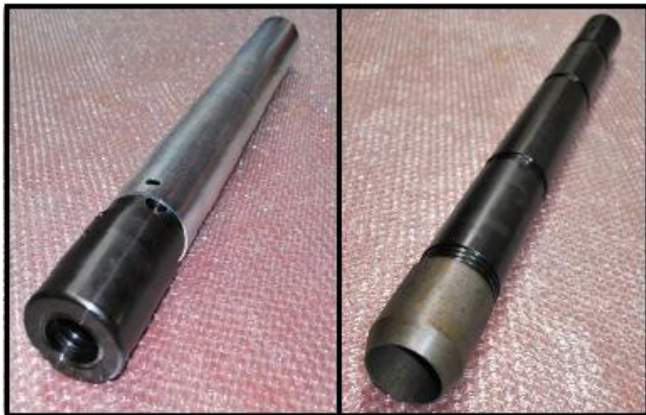
Figura 2.15 Tubos para toma de muestras inalteradas. Izquierda tubo Shelby, derecha barril Denison.
