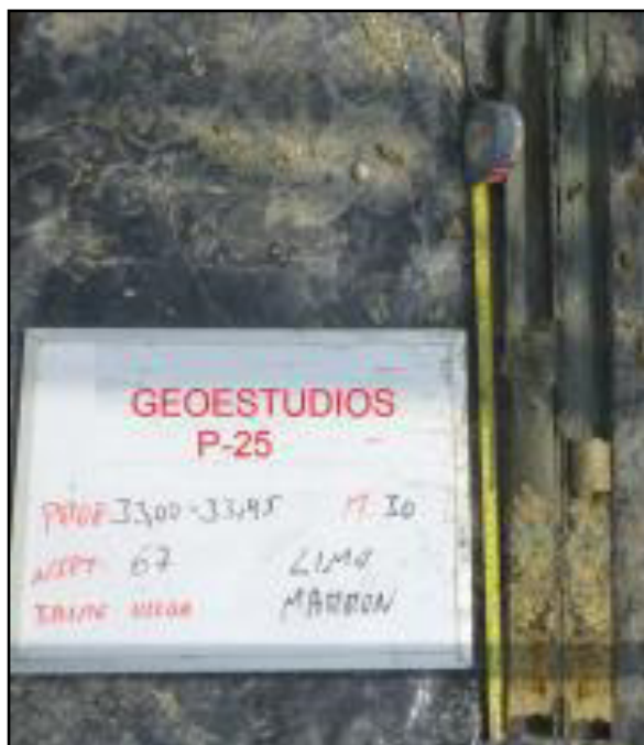
Figura 2.18 Muestra de suelo obtenida con penetrómetro estándar.
