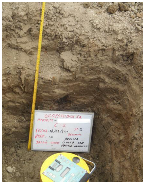
Figura 2.19 Ejecución de una calicata con toma de datos de Geogauge.
