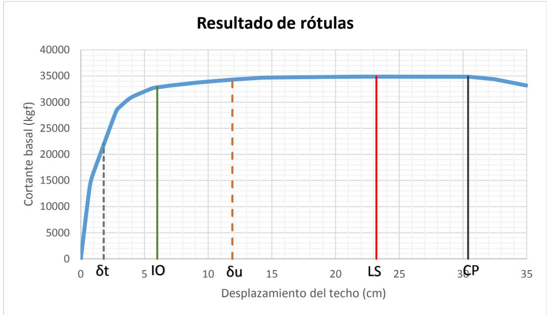
**Figura C.13:** Nivel de desempeño para columnas del arquetipo 5.
