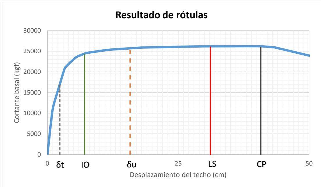
**Figura C.22:** Nivel de desempeño para columnas del arquetipo 8.
