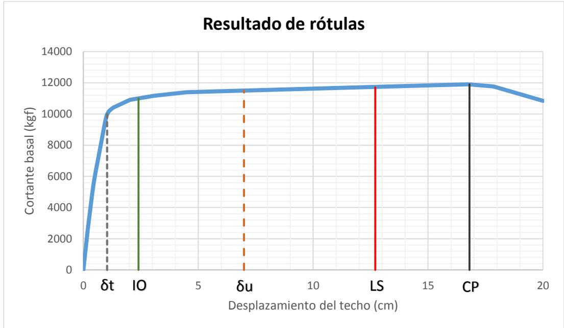
**Figura C.7:** Nivel de desempeño para columnas del arquetipo 3.
