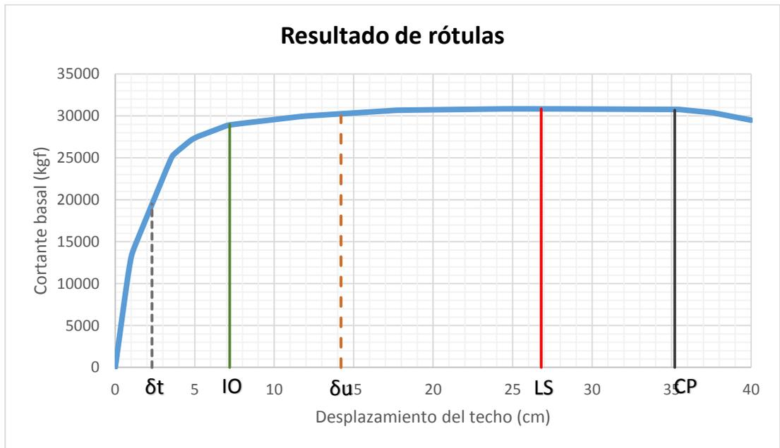
**Figura C.16:** Nivel de desempeño para columnas del arquetipo 6.
