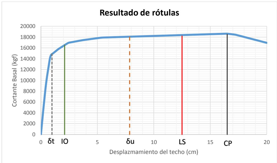
**Figura C.4:** Nivel de desempeño para columnas del arquetipo 2.
