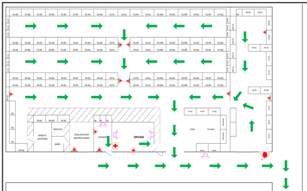
Figura 3.11 Plano de evacuación de bodega
