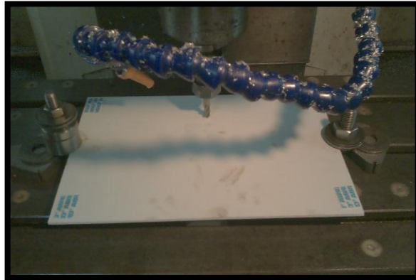
FIGURA 3.9. COLOCACIÓN DEL CERO DE PIEZA EN MAQUINA CNC
