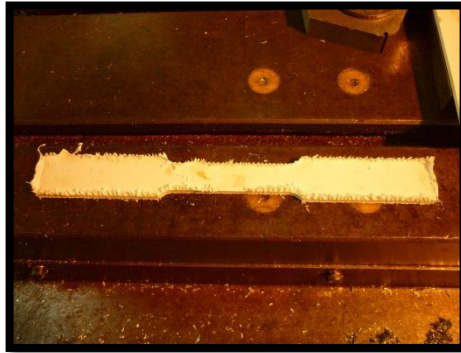
FIGURA 3.12. PIEZA OBTENIDA EN LA FRESADORA CONVENCIONAL
