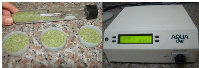
**Figura 2.17** Muestras del Condimento y Medidor de Aw Aqua Lab
