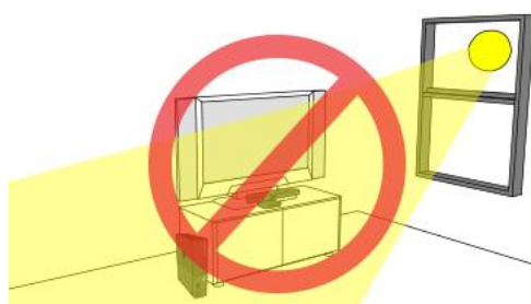
Figura 3.16. Incorrecta iluminación del sensor Kinect [18]
