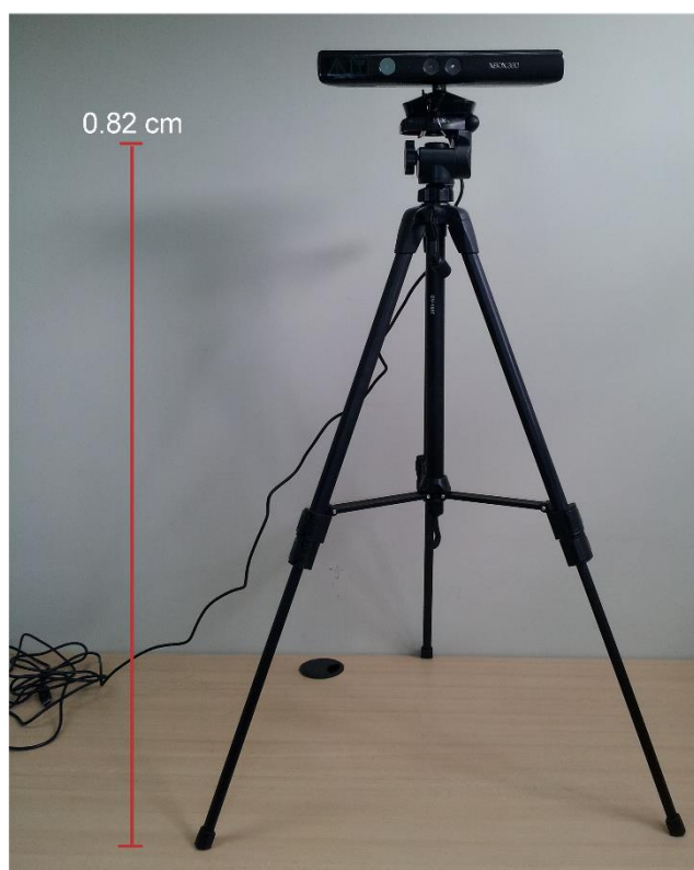
Figura 3.17. Altura del sensor Kinect usando un trípode de soporte
