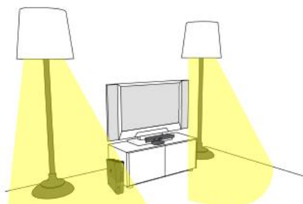
Figura 3.15. Correcta iluminación del sensor Kinect [18]
