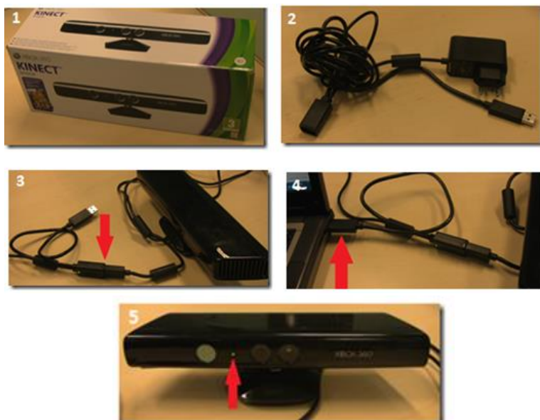
Figura 3.1. Proceso de conectar el Kinect al computador [13]
