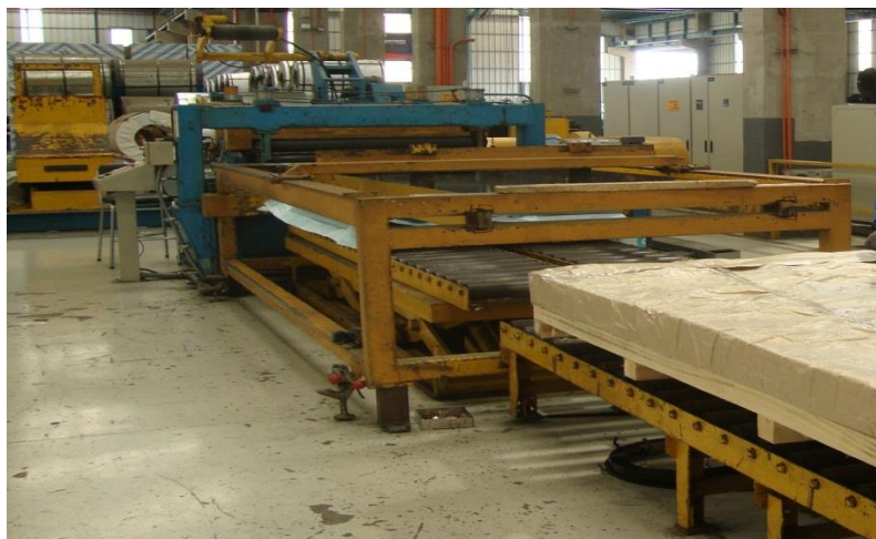
FIGURA 3.5. Equipo de Corte Transversal
