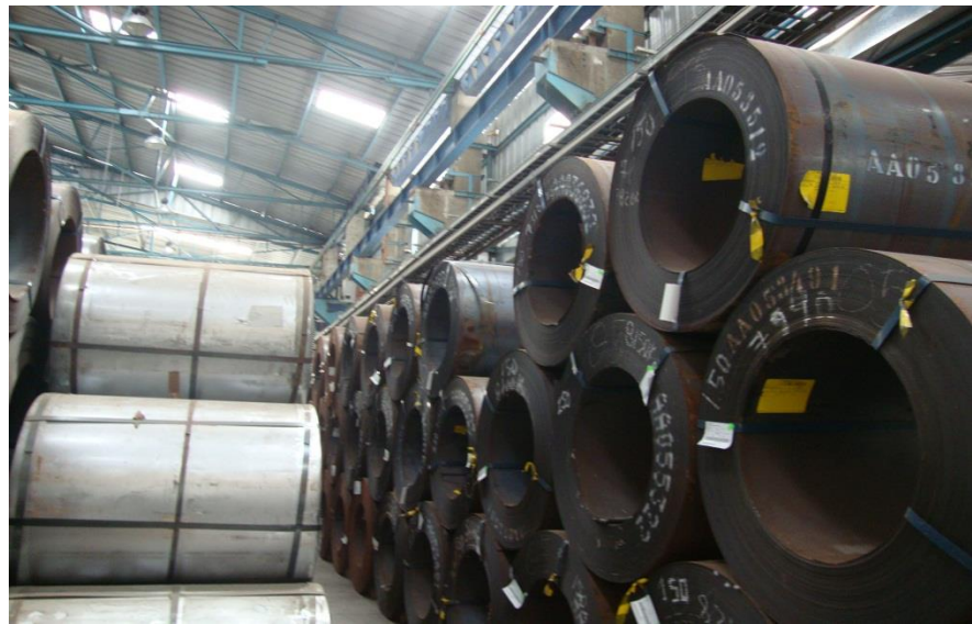
FIGURA 3.2. Almacenamiento de Bobinas de Acero
