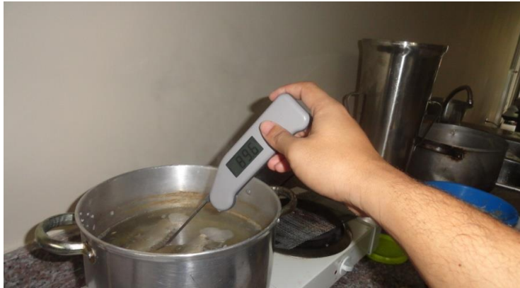
FIGURA 2.7 CONTROL DE LA TEMPERATURA DEL MEDIO DE CALENTAMIENTO
