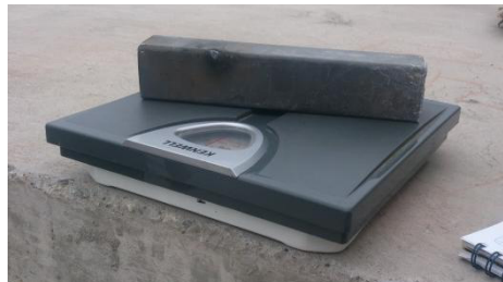
Fotografía 3.13: Pesaje de la muestra del material Perfil Metálico
