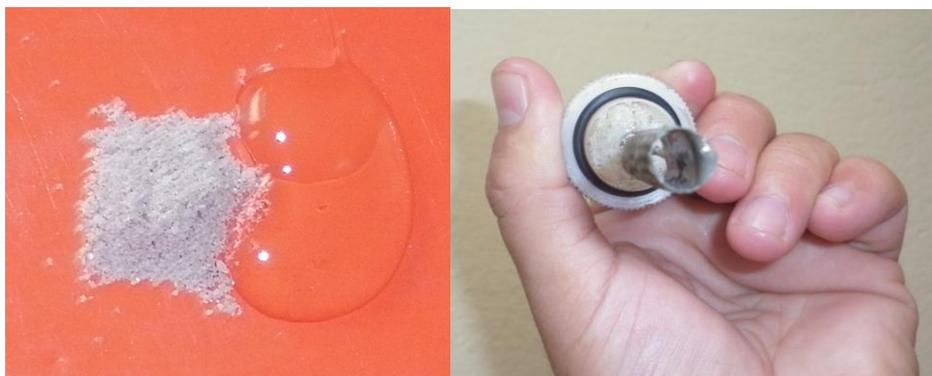
**FIGURA 2.9 APLICACIÓN SOBRE LA SOLDADURA DE RESINA EPOXY JUNTO CON EL CLORURO DE PLATA (AgCl)**
