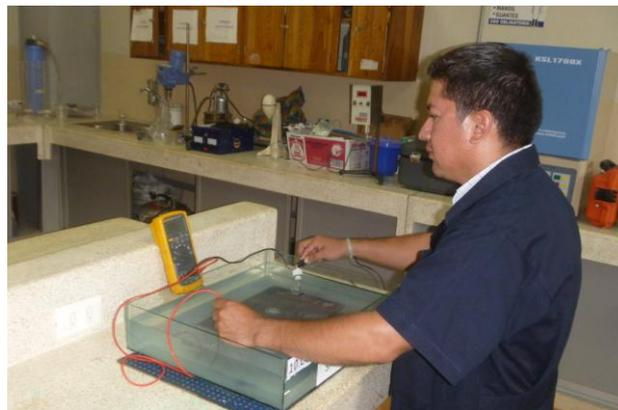
**FIGURA 3.1 MEDICIÓN DE POTENCIAL SOBRE UNA PLACA DE ACERO ASTM A588 SUMERGIDA EN AGUA DE MAR**
