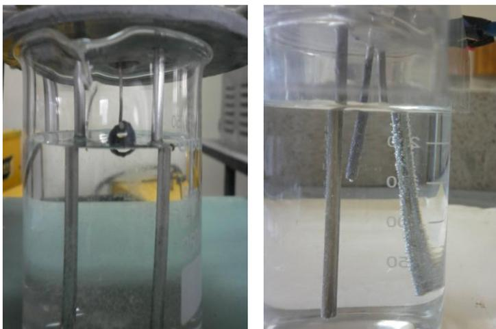
**FIGURA 2.7 ELECTROLISIS PARA LA FORMACIÓN DEL CLORURO DE PLATA**
