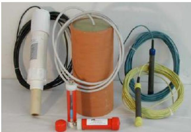
**FIGURA 1.20 ELECTRODOS DE REFERENCIA COMERCIALES**
