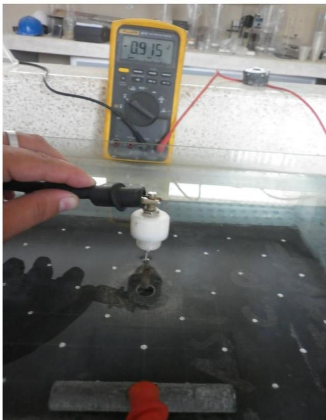
**FIGURA 3.10 POTENCIAL ELECTRODO PATRÓN**
