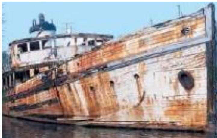
**FIGURA 1.3 CORROSIÓN QUÍMICA DE UN BUQUE**
