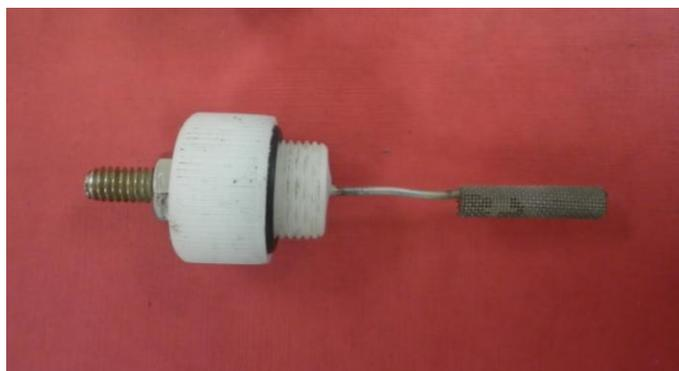
**FIGURA 1.23 ELECTRODO PLATA/CLORURO DE PLATA**
