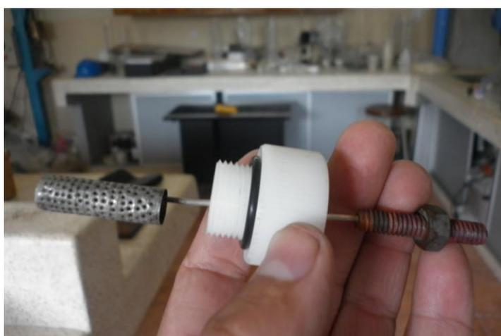
**FIGURA 2.1 SOLDADURA DEL ALAMBRE DE PLATA AL ESPÁRRAGO**
