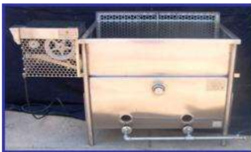
Figura 3.6.2.a Escaldadora de Aspas
