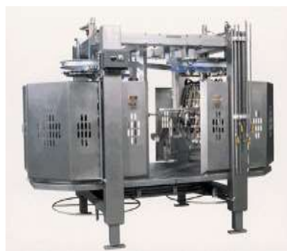
Figura 3.6.3.i Máquina Abridora de Abdomen
