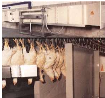
Figura 3.6.3.c Aturdidor de Alta Frecuencia
