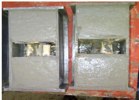
FIGURA 2.6: PROBETAS LISTAS PARA EL PROCESO DE CURADO.
