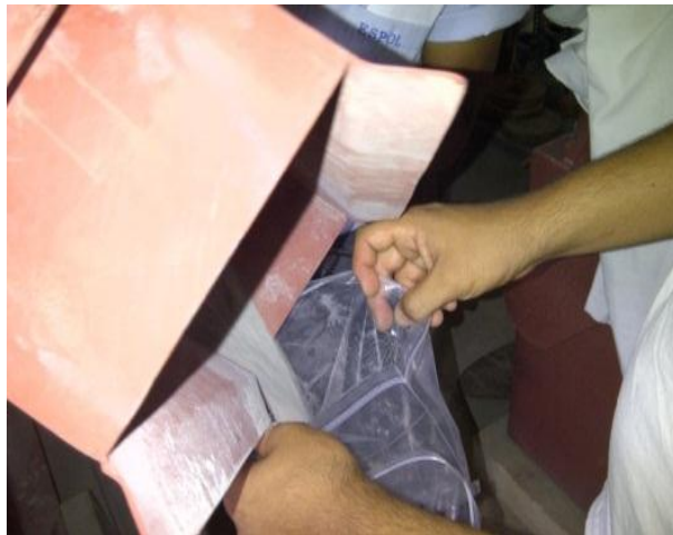
FIGURA 2.43: MUESTRA PASADA EN TRITURADORA DE RODILLOS.
