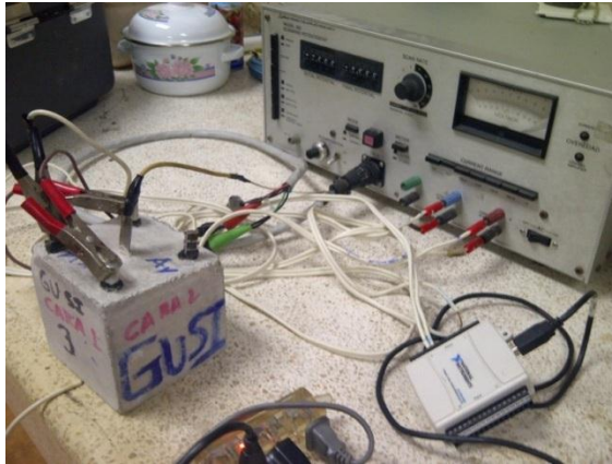
FIGURA 7. CONEXIÓN DEL POTENCIOGALVANOSTATO
