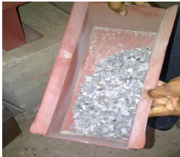
FIGURA 2.41: MUESTRA PASADA EN TRITURADORA DE MANDÍBULAS.
