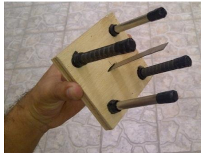
FIGURA 2.3: TABLA DE MADERA DE 10 x10 cm ANTES DE SER COLOCADO EN EL MOLDE METÁLICO.
