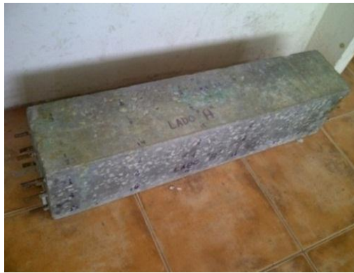
FIGURA 2.12: PROBETA RECTANGULAR DE HORMIGÓN ARMADO TERMINADA.
