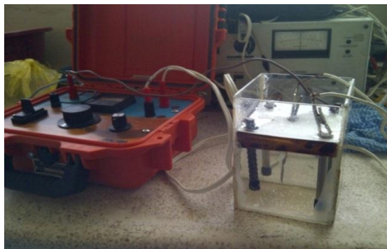
FIGURA 2.27: MEDICIÓN DE RESISTENCIA DE LA CELDA.
