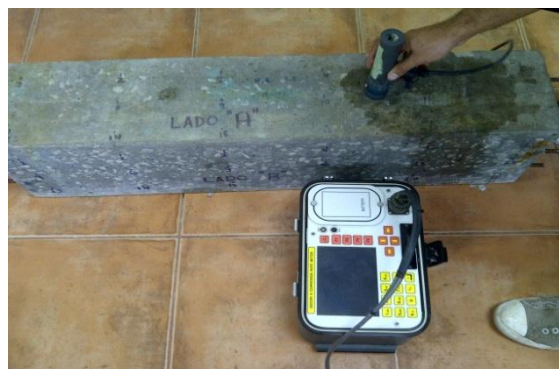
FIGURA 2.32: COLOCACIÓN DEL SENSOR B EN EL PUNTO DE MEDICIÓN.
