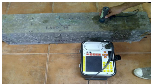
FIGURA 7. COLOCACIÓN DEL SENSOR B EN EL PUNTO DE MEDICIÓN.
