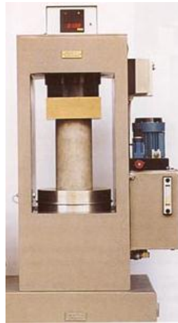
FIGURA 2.16: ESQUEMA DE ENSAYO DE ROTURA POR COMPRESIÓN.
