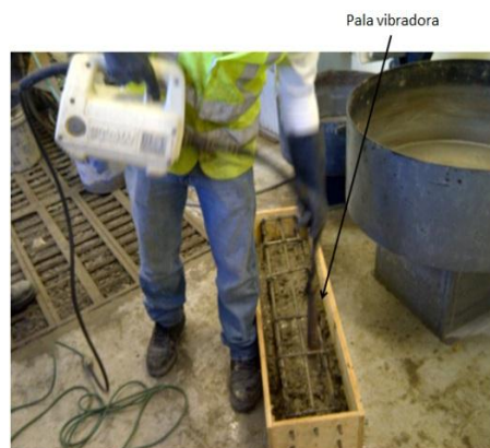
FIGURA 2.11: PALA VIBRADORA PARA LA DISTRIBUCIÓN UNIFORME DEL CEMENTO EN EL MOLDE.
