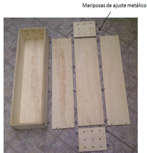
FIGURA 2.9: MOLDES DE MADERA ARMADO Y DESARMADO.
