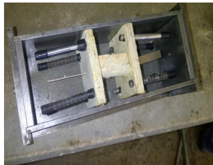
FIGURA 2.4: MOLDE LISTO PARA LA COLADA DEL CEMENTO. CADA MOLDE ESTÁ PREPARADO PARA COLAR DOS PROBETAS.
