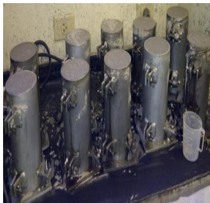
FIGURA 2.15: PROBETAS LISTAS PARA EL PROCESO DE CURADO.
