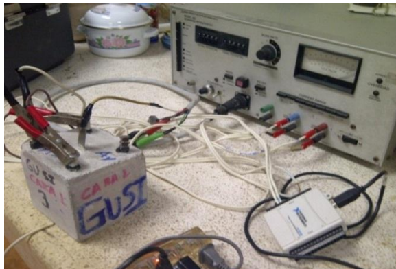
FIGURA 2.26: CONEXIÓN DEL POTENCIO-GALVANOSTATO.
