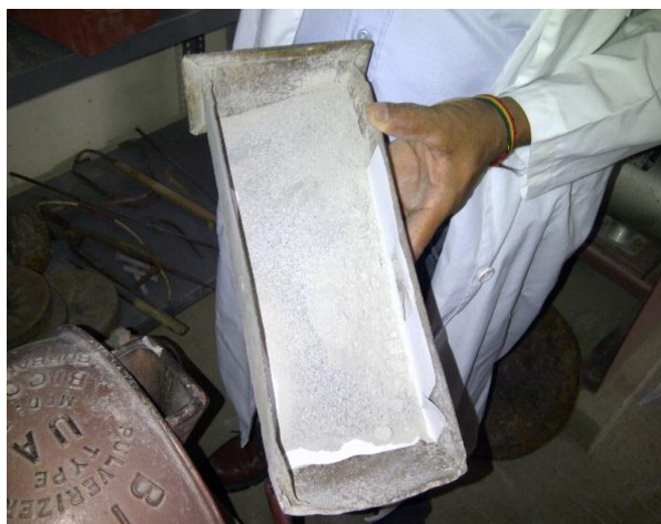
FIGURA 2.45: MUESTRA PASADA EN TRITURADORA DE RODILLOS.
