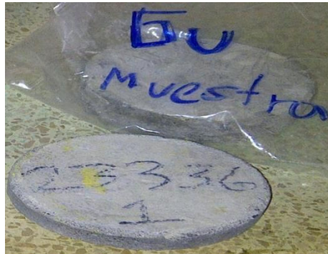
FIGURA 2.39: REBANADA DE HORMIGÓN LIMPIA Y LISTA PARA SER TRITURADA.
