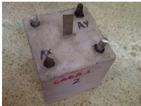
FIGURA 2.7: PROBETA CÚBICA DE HORMIGÓN ARMADO TERMINADA.
