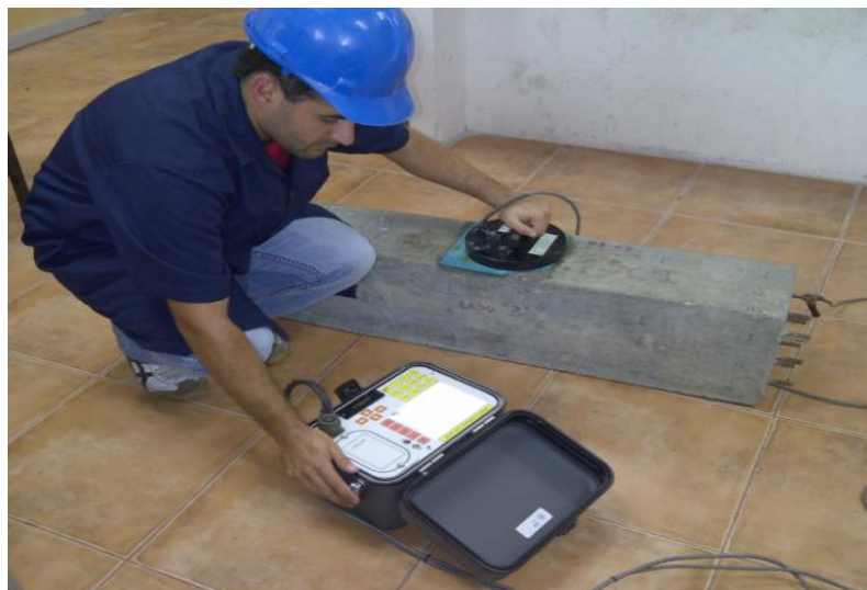
FIGURA 9. COLOCACIÓN DEL SENSOR A EN EL PUNTO DE MEDICIÓN.
