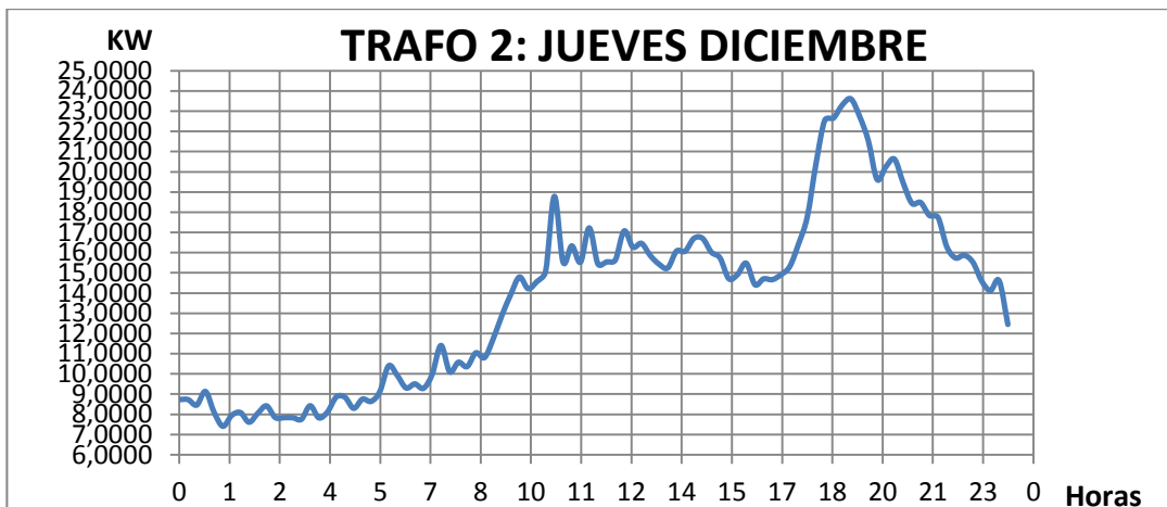
Figura 3. 25 Curva de Carga de Diciembre del transformador 2 el día jueves
