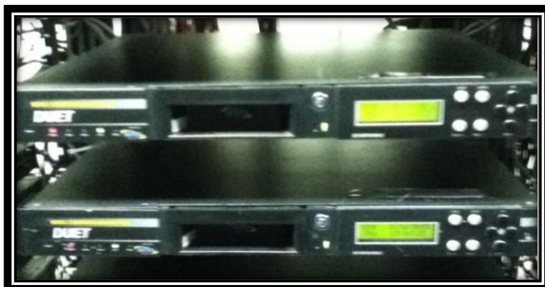
Figura 4. 6. Equipo Duet.- Encargado de agregar la programación local.
