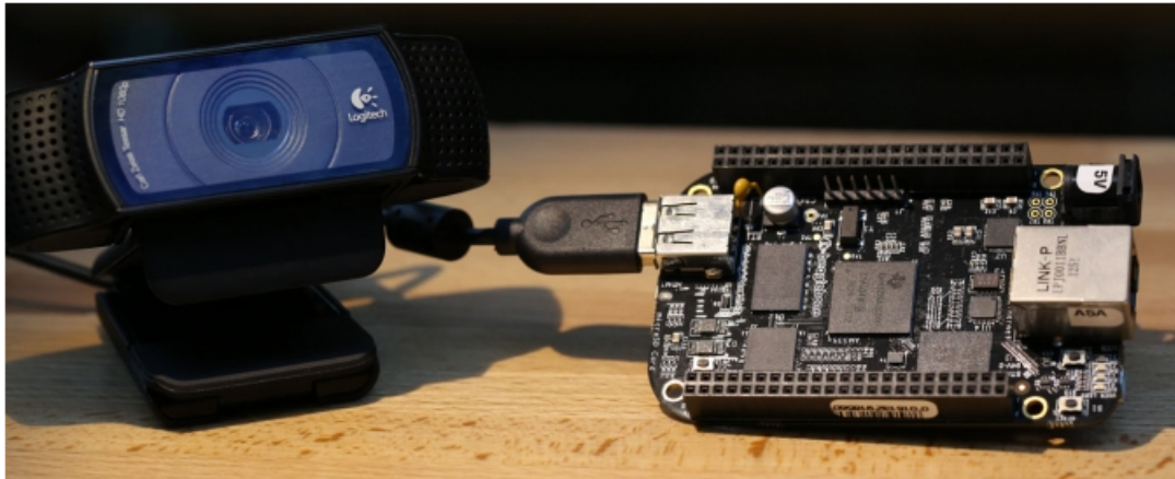
Figura 3.3: Conexión de una cámara USB y el Beaglebone
