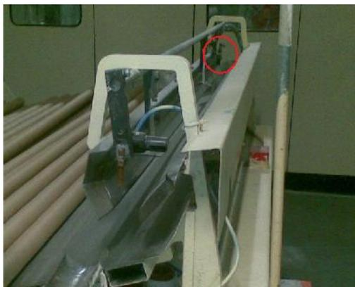
Figura 3.6. Sensor fotoeléctrico largo de canuto.
