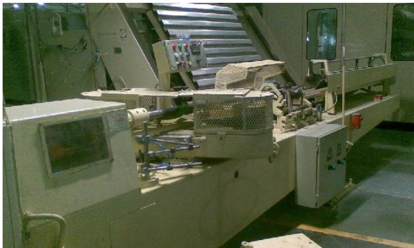
Figura 2.1. Máquina formadora de canutos.
