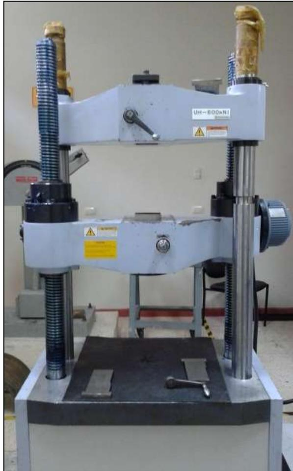
FIGURA 3.8. MÁQUINA DE ENSAYOS UNIVERSALES.
