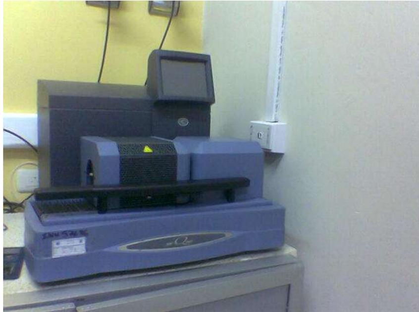
FIGURA 3.7. ANALIZADOR TERMOGRAVIMÉTRICO.
