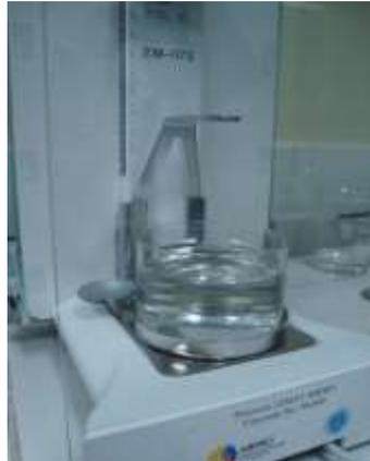
FIGURA 3.23. DETERMINACIÓN DE LA DENSIDAD DE LA ZEOLITA ACTIVADA ALCALINAMENTE.
