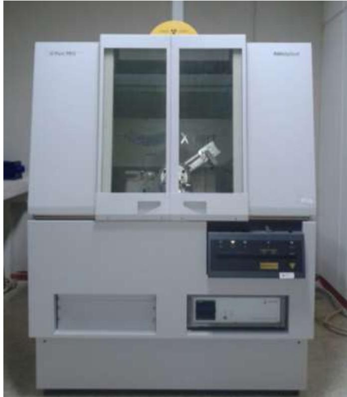
FIGURA 3.4. DIFRACTÓMETRO DE RAYOS X.
