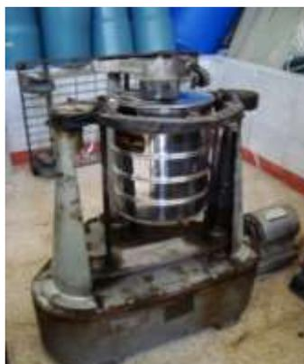
FIGURA 3.2. AGITADOR DE TAMICES.
