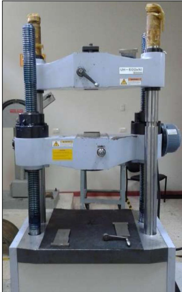
FIGURA 3.8. MÁQUINA DE ENSAYOS UNIVERSALES.
