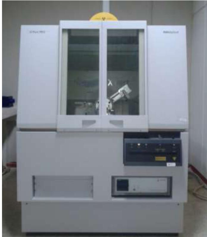
FIGURA 3.4. DIFRACTÓMETRO DE RAYOS X.
