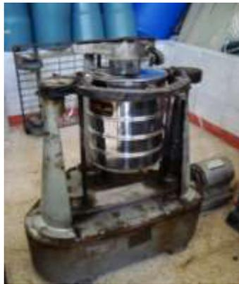
FIGURA 3.2. AGITADOR DE TAMICES.
