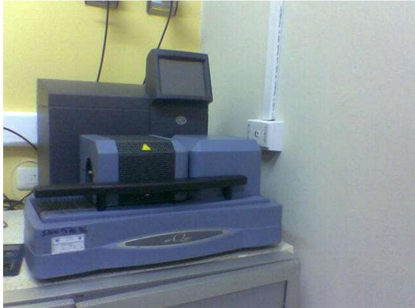
FIGURA 3.7. ANALIZADOR TERMOGRAVIMÉTRICO.
