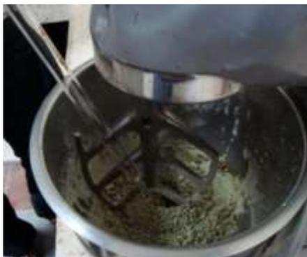
FIGURA 3.13. PREPARACIÓN DE LA MUESTRA G1\_P1 CUANDO SE HA AGREGADO 60mL DE HIDRÓXIDO DE SODIO.
