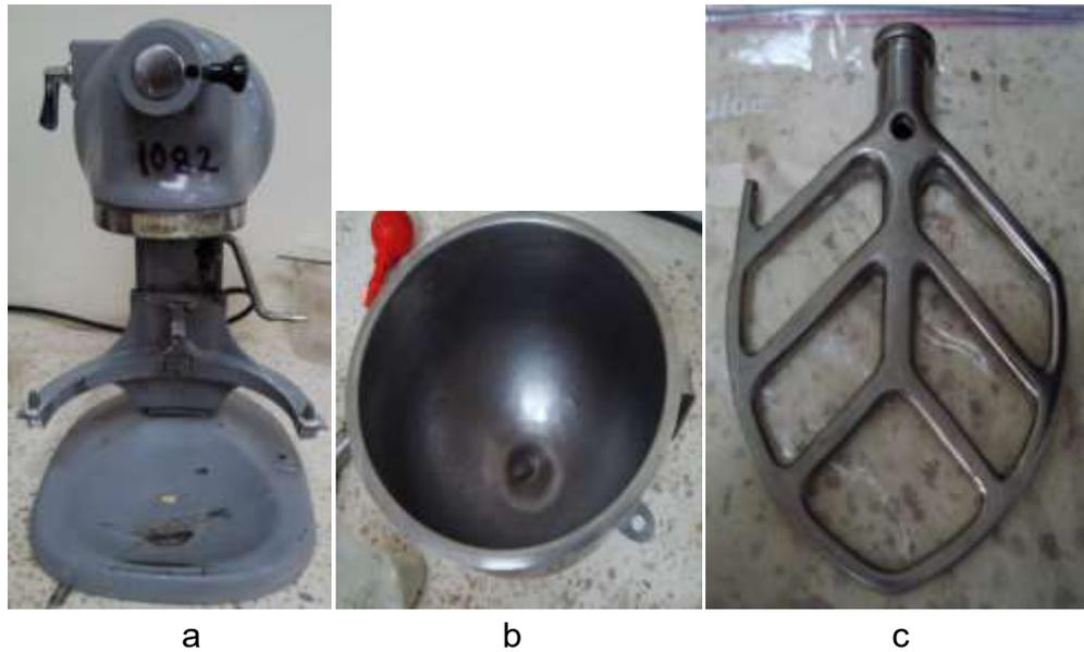
FIGURA 3.9. MEZCLADORA: A) MÁQUINA MEZCLADORA, B) RECIPIENTE, C) PALETA.
