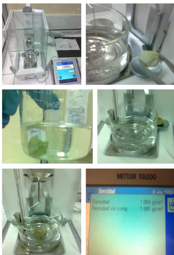
Figura 3.9. Pasos para la medición de la densidad.
