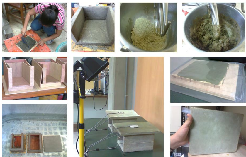
Figura 3.6. Preparación de las partes de mortero y geopolímeros.
