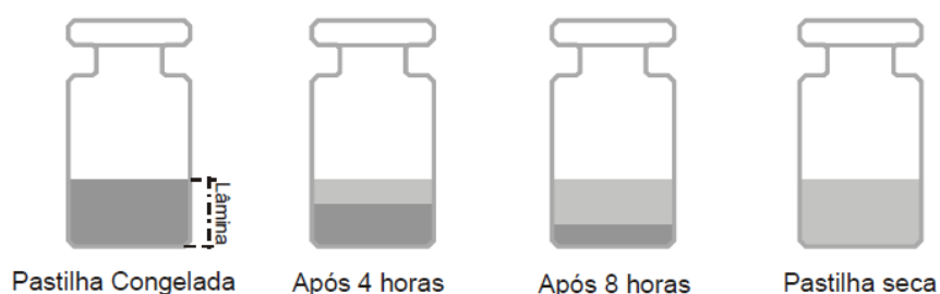
Figura 1.8. Superficie de sublimación (seca) profundizando en la pastilla congelada
