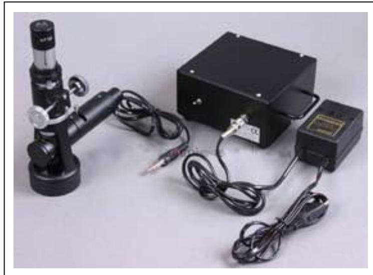
**FIGURA 1.6.- MICROSCOPIO METALOGRÁFICO PORTÁTIL**
