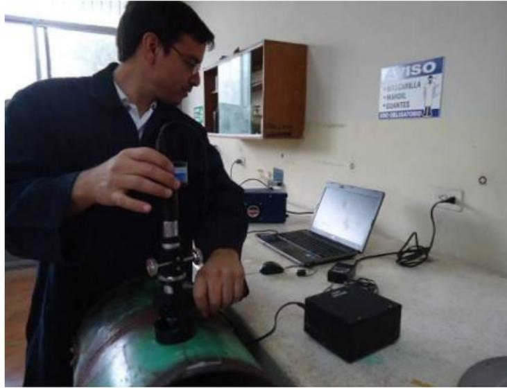
**FIGURA 4.6.- OBTENCIÓN DE IMAGEN DIGITAL DE LA MICROESTRUCTURA**
