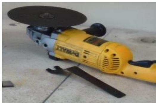
**FIGURA 2.1.- AMOLADORA Y DISCO DE DESBASTE PARA
