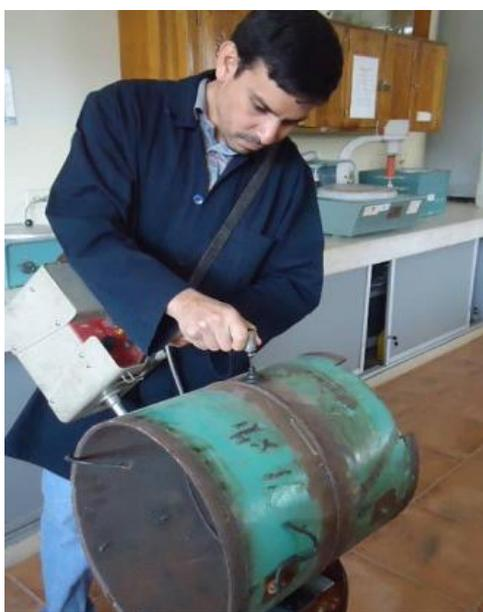
**FIGURA 4.2.- DESBASTE FINO CON EQUIPO PORTÁTIL**
