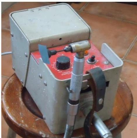
**FIGURA 2.4.- EQUIPO PORTÁTIL PARA DESBASTE Y PULIDO**
