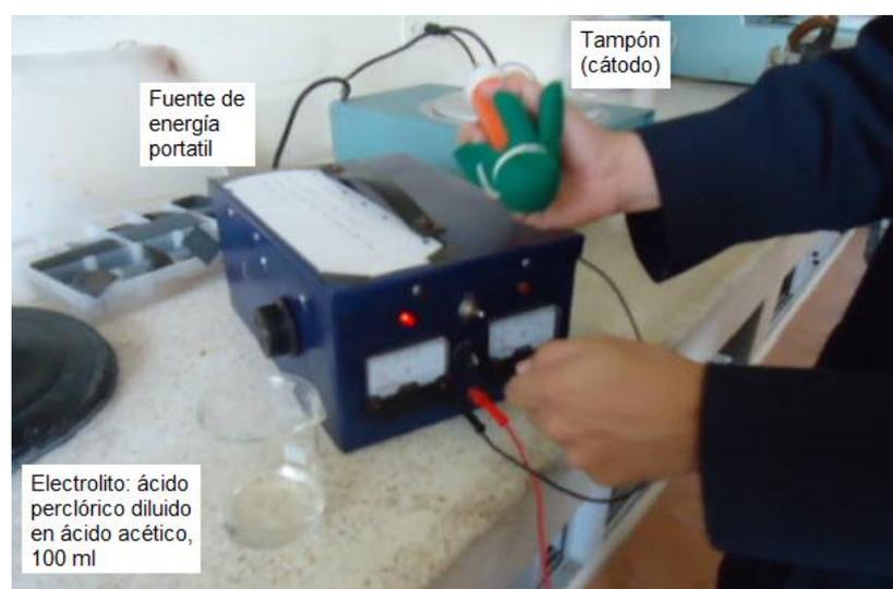
**FIGURA 2.5.- CELDA ELECTROLÍTICA PARA REALIZAR ELECTROPULIDO**
