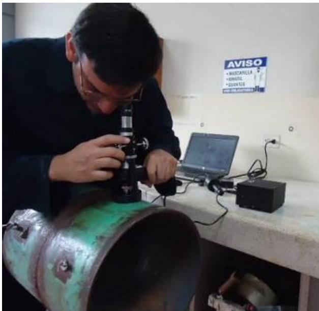
**FIGURA 4.5.- OBTENCIÓN DE MICROESTRUCTURA CON MICROSCOPIO METALGRÁFICO PORTÁTIL**
