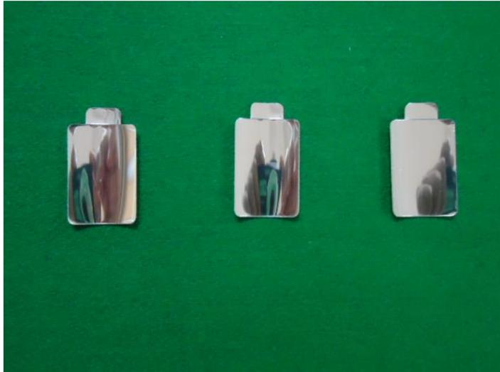
**FIGURA 2.7.- LÁMINAS DE ACETATO CON SOPORTE DE ALUMINIO**
