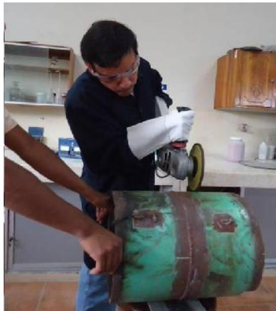
**FIGURA 4.1.- DESBASTE GRUESO CON AMOLADORA Y DISCO DE DESBASTE**
