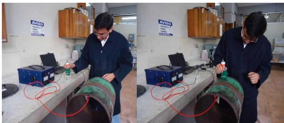
**FIGURA 4.3.- PULIDO ELECTROLÍTICO A TUBERÍA DE GLP**
