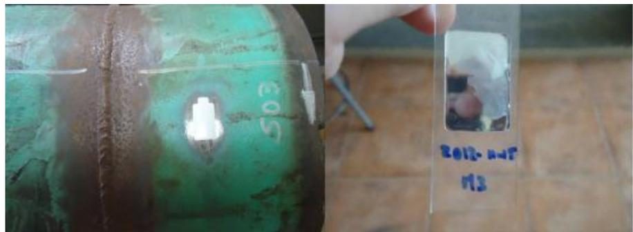
**FIGURA 4.4.- OBTENCIÓN DE MICROESTRUCTURAS CON LÁMINAS DE ACETATO**
