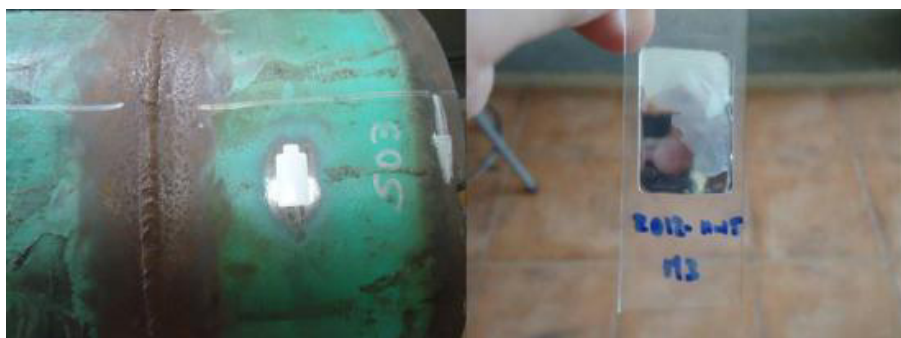
FIGURA 4.4.- OBTENCIÓN DE MICROESTRUCTURAS CON LÁMINAS DE ACETATO
