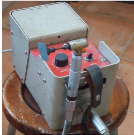
FIGURA 2.4.- EQUIPO PORTÁTIL PARA DESBASTE Y PULIDO
