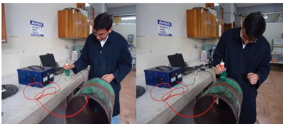
FIGURA 4.3.- PULIDO ELECTROLÍTICO A TUBERÍA DE GLP
