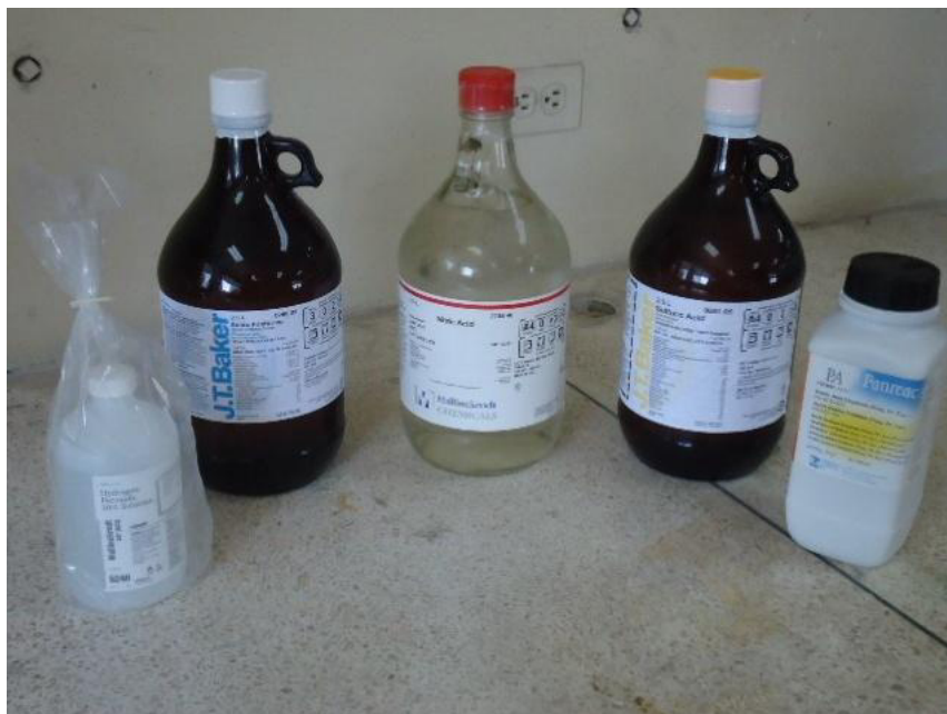
FIGURA 2.6.- COMPUESTOS QUÍMICOS UTILIZADOS PARA LA PREPARACIÓN DE ELECTRÓLITOS PARA ELECTROPULIDO
