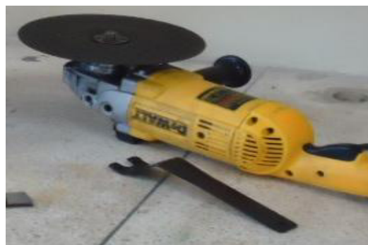
FIGURA 2.1.- AMOLADORA Y DISCO DE DESBASTE PARA DESBASTE GRUESO
