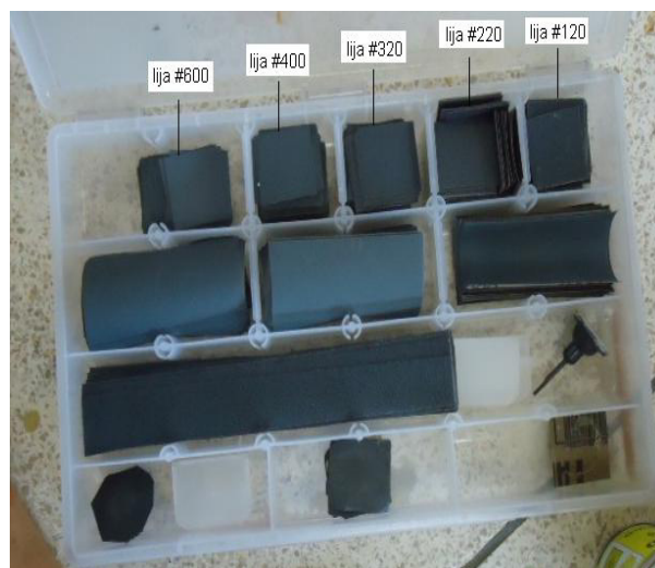
FIGURA 2.3.- LIJAS ACOPLADAS AL EQUIPO PORTÁTIL PARA DESBASTE FINO
