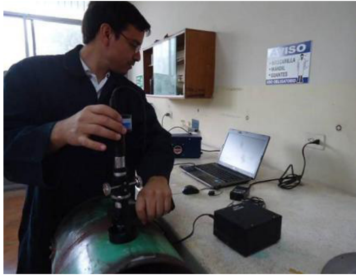
FIGURA 4.6.- OBTENCIÓN DE IMAGEN DIGITAL DE LA MICROESTRUCTURA
