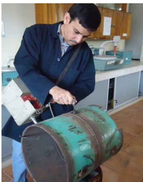
FIGURA 4.2.- DESBASTE FINO CON EQUIPO PORTÁTIL
