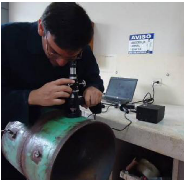
FIGURA 4.5.- OBTENCIÓN DE MICROESTRUCTURA CON MICROSCOPIO METALGRÁFICO PORTÁTIL
