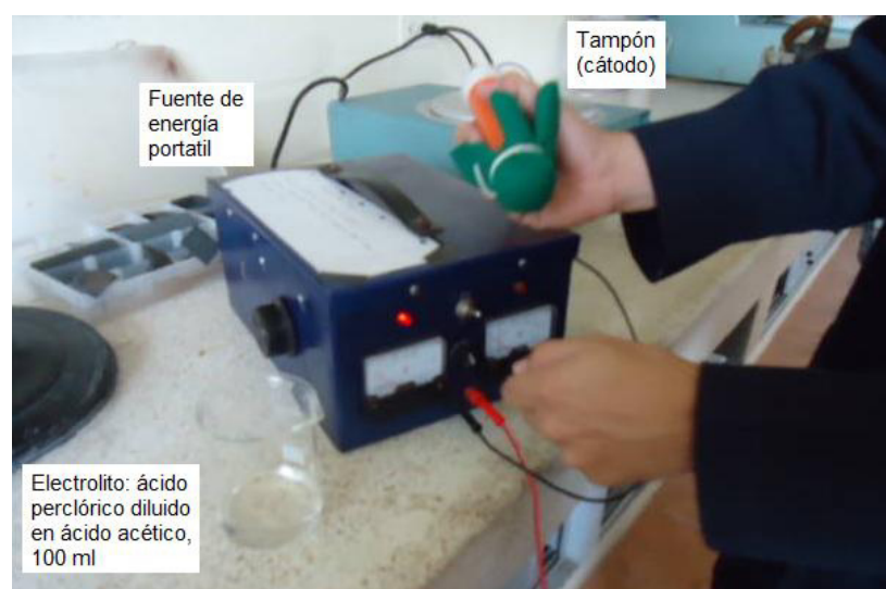
FIGURA 2.5.- CELDA ELECTROLÍTICA PARA REALIZAR ELECTROPULIDO
