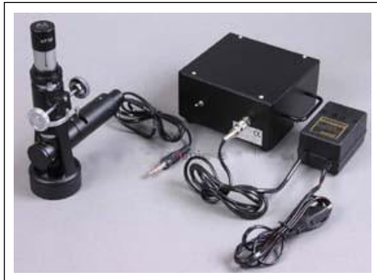
FIGURA 1.6.- MICROSCOPIO METALOGRÁFICO PORTÁTIL
