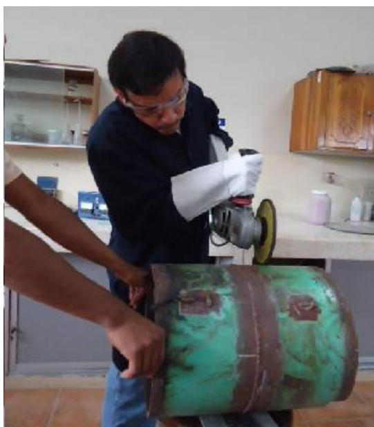
FIGURA 4.1.- DESBASTE GRUESO CON AMOLADORA Y DISCO DE DESBASTE
