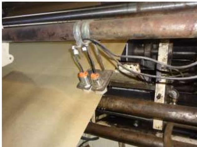
Figura 3.7 Sensores de nivel y humedad
