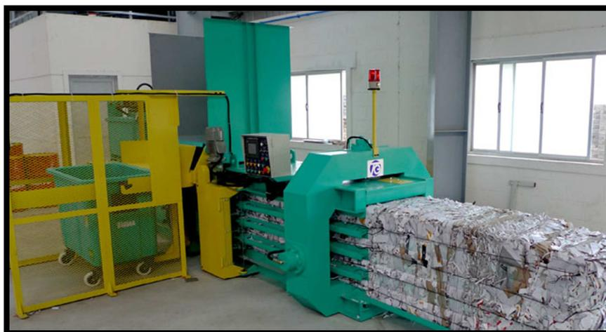
**FIGURA 2.7 SISTEMA DE EMPACADO DE DESPERDICIOS.**
