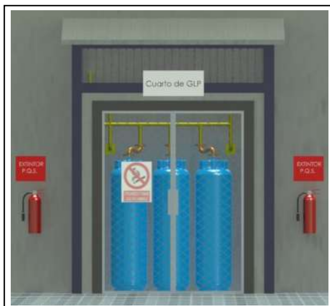
Figura 5.11. Cuarto de hormigón para tanques de GLP
