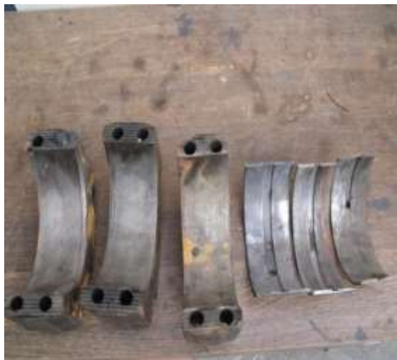
FIGURA 2.5 CEPOS DE BRAZOS DE BIELA Y CHAPAS DE BIELA DEFORMADOS.
