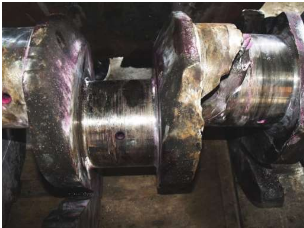
FIGURA 2.22 PATRÓN DE FRACTURA DE LA POSICIÓN Nº 7 Y POSICIÓN Nº 8.
