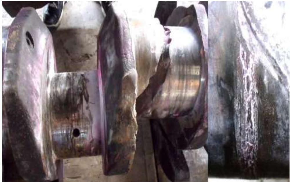
FIGURA 2.19 RAYADURA Y ADHERENCIA DE METAL BABBIT EN LA POSICIÓN 7 Y 8 EN EL CIGUEÑAL.
