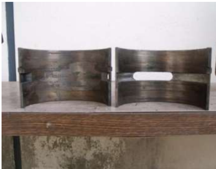
FIGURA 2.7 CHAPAS DE BIELA SIN MATERIAL NFITRION
