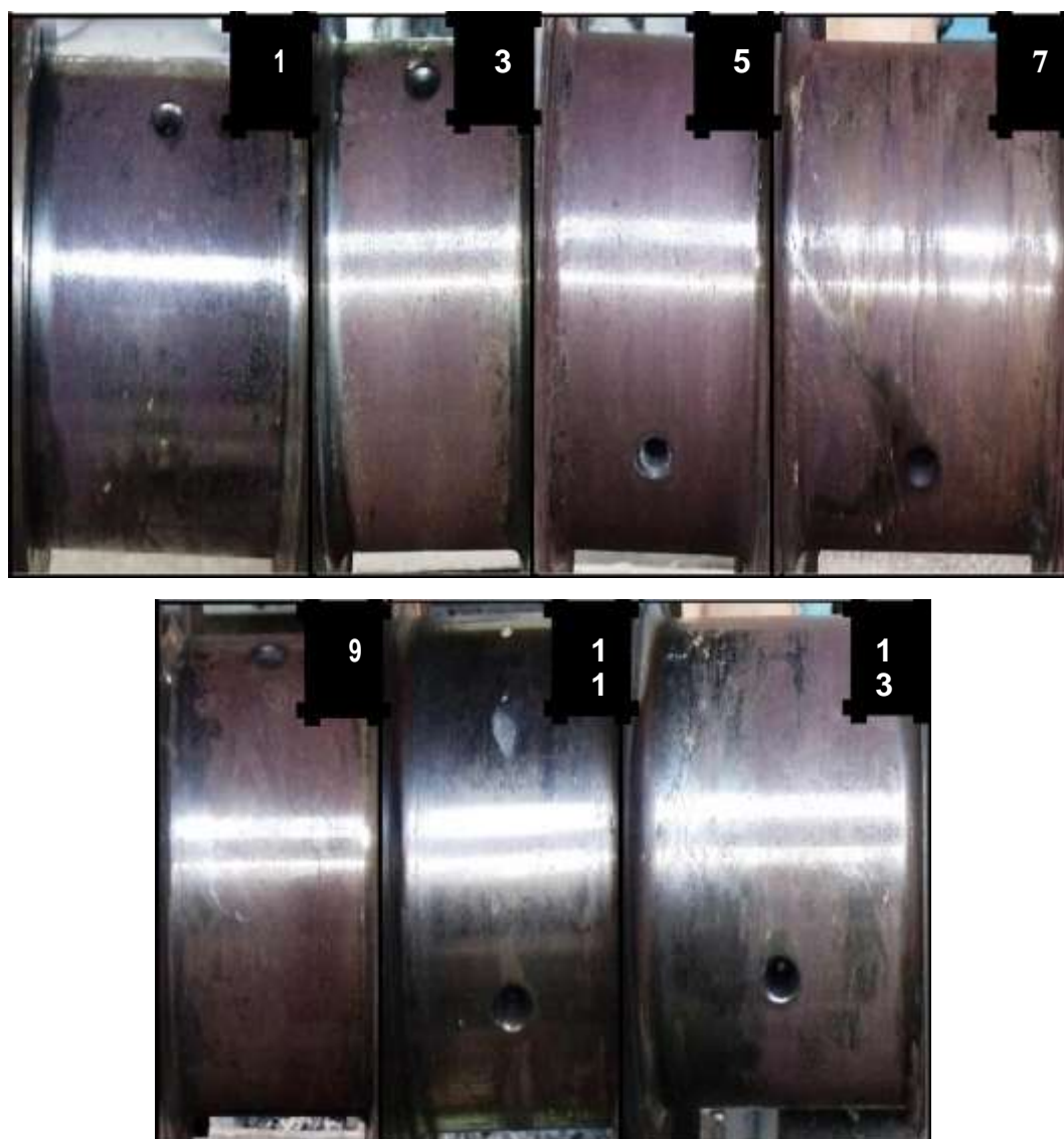
FIGURA 2.17 AFECTACIONES SOBRE LAS SUPERFICIES DE LOS SIETE MUÑONES DE BANCADA.
