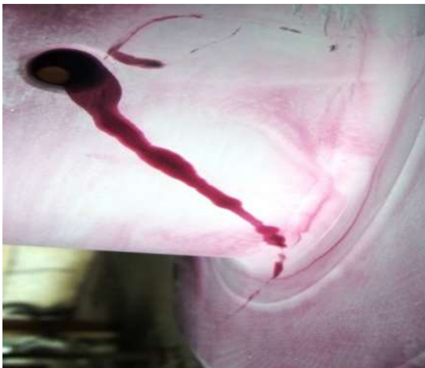
FIGURA 2.21 ACERCAMIENTO DE MUÑÓN DE BANCADA EN LA POSICIÓN N° 7 Y ENSAYADA CON TINTAS PENETRANTES.
