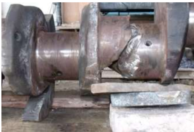
FIGURA 2.6 MUÑON DE BIELA FRACTURADO
