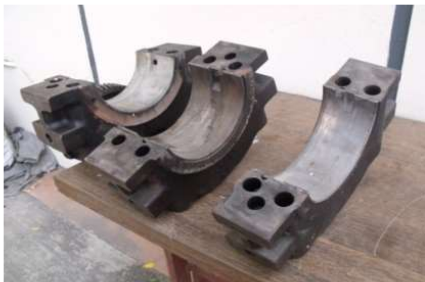
FIGURA 2.8 CEPÓS E BANCADA DEFORMADOS
