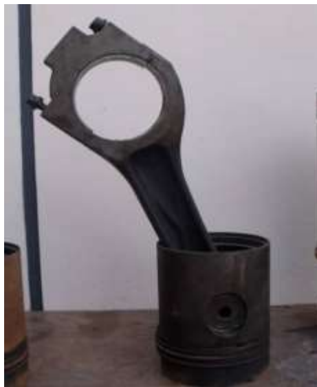
FIGURA 2.3 EN EL CUARTO PISTÓN CON RAYADURAS Y RINES PEGADOS
