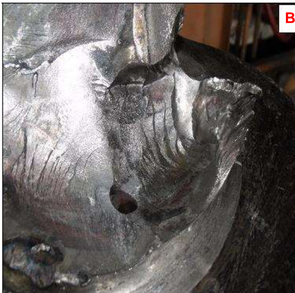
FIGURA 2.25 ORIGEN DE LA RUPTURA DEL CIGÜEÑAL
