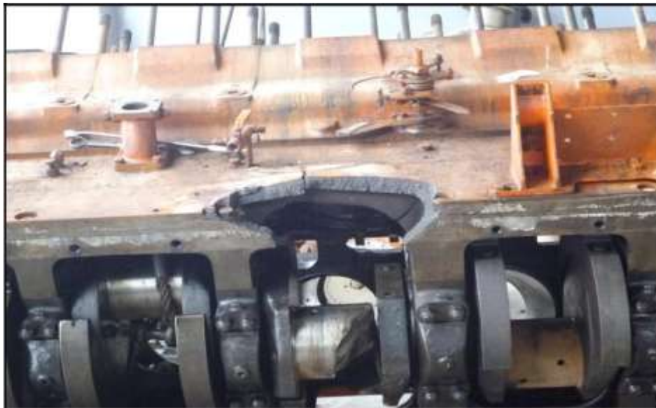
FIGURA 2.1 FRACTURA EXTERNA DEL BLOCK
