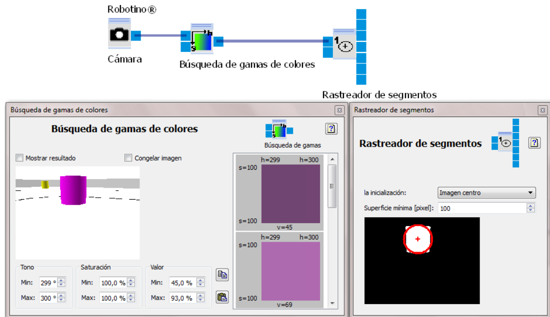
FIGURA 3.34: USO DE BLOQUE “RASTREADOR DE SEGMENTOS”; PASO 1 PRÁCTICA 6.
