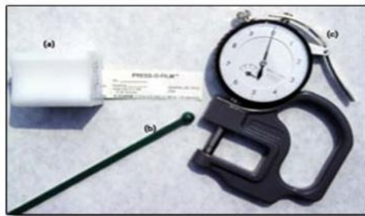
FIGURA 4.4 MEDICIÓN DE PERFIL DE ANCLAJE – MÉTODO C
